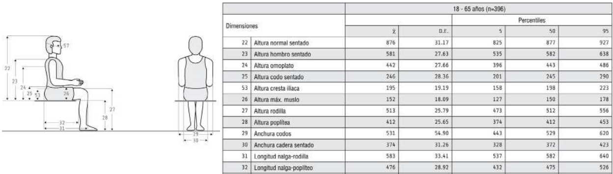
Fig. 5 Medidas de una silla de uso múltiple
